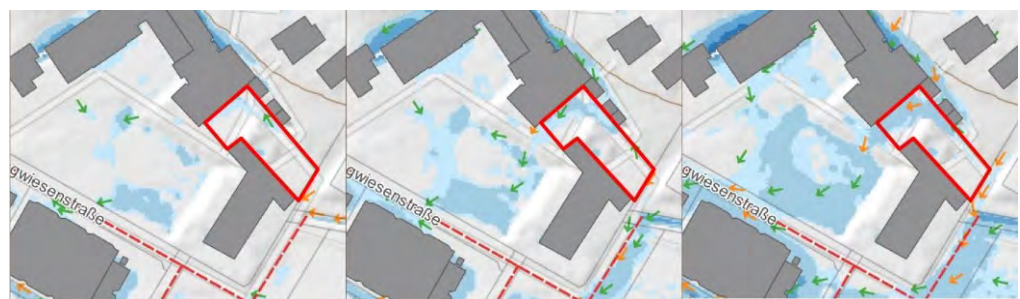
Abbildung 29 - Ausschnitte der Starkregengefahrenkarten – Parkplatz Nord - mit den Abflussszenarien (v.l.n.r. selten, außergewöhnlich, extrem) (Ingenieurbüro Heberle, Juni 2023)
