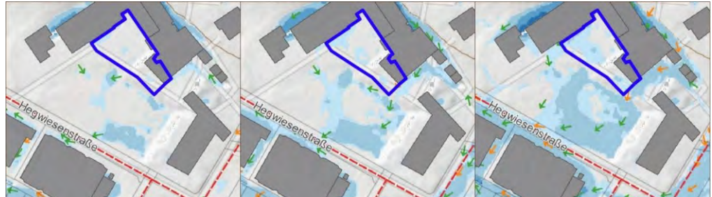
Abbildung 30 - Ausschnitte der Starkregengefahrenkarten – Gebäudenaher Pausenhof - mit den Abflussszenarien (v.l.n.r. selten, außergewöhnlich, extrem) (Ingenieurbüro Heberle, Juni 2023)
