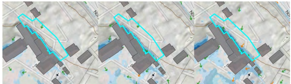
Abbildung 33 - Ausschnitte der Starkregengefahrenkarten – Zugänge Nord - mit den Abflussszenarien (v.l.n.r. selten, außergewöhnlich, extrem) (Ingenieurbüro Heberle, Juni 2023)
